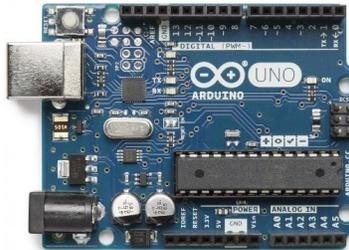
**Figura 2. Placa do Arduino**
